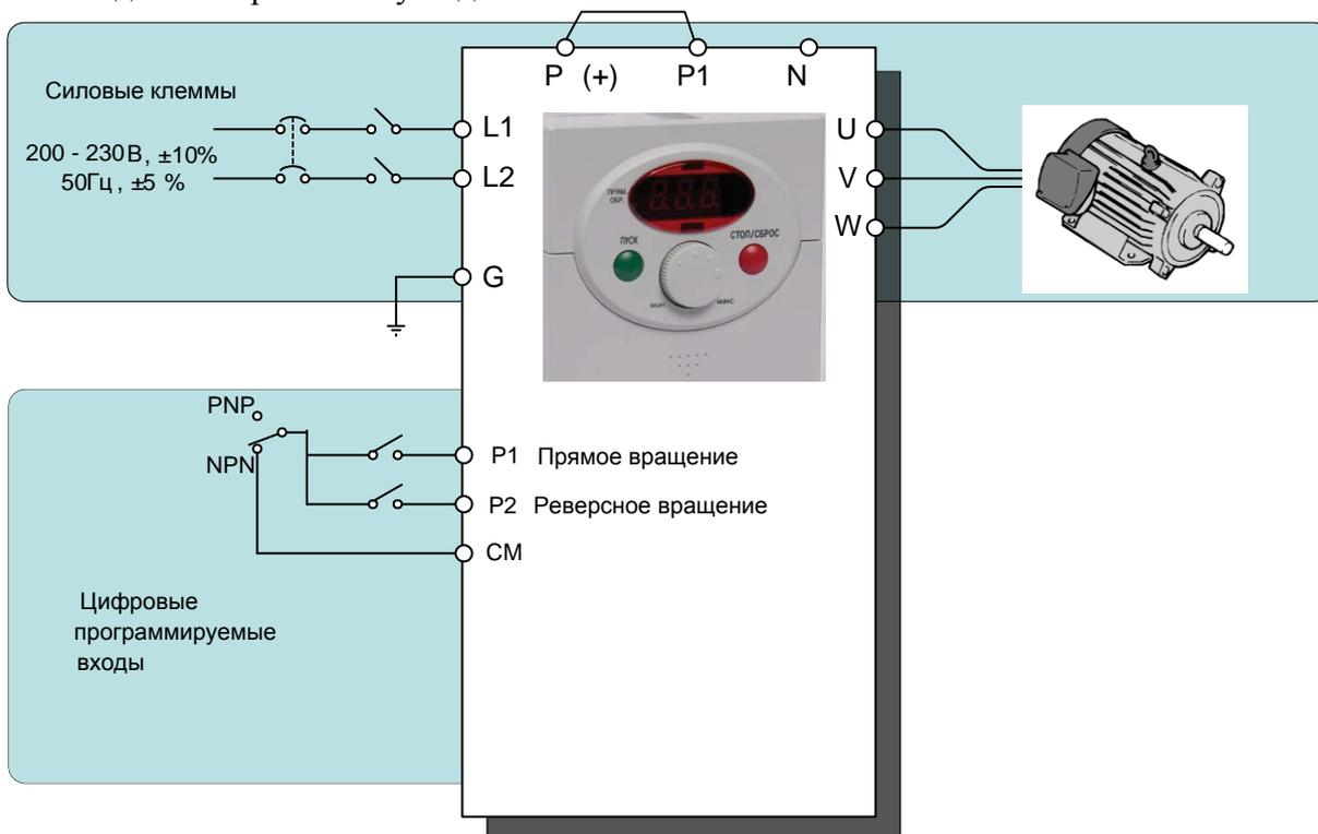
Отнеситесь внимательно к клемме заземления! - Это клемма G!
