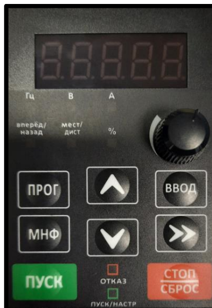
Рис. 4-1 б. Панель управления. Расположение кнопок управления и индикация
